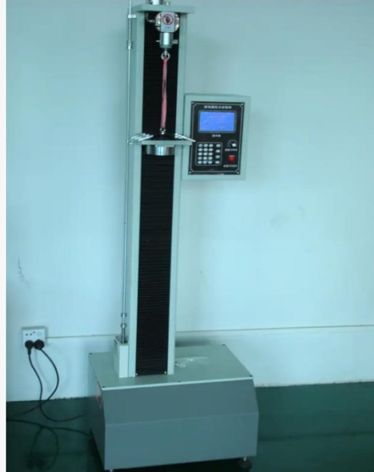
焊接拉力检测
